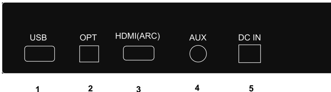
1. **USB IN :** Connexion pour MP3 / WAV (format FAT32 et 128 Go max), câble non fourni.
